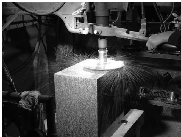
手動研磨機による研磨作業のようす
