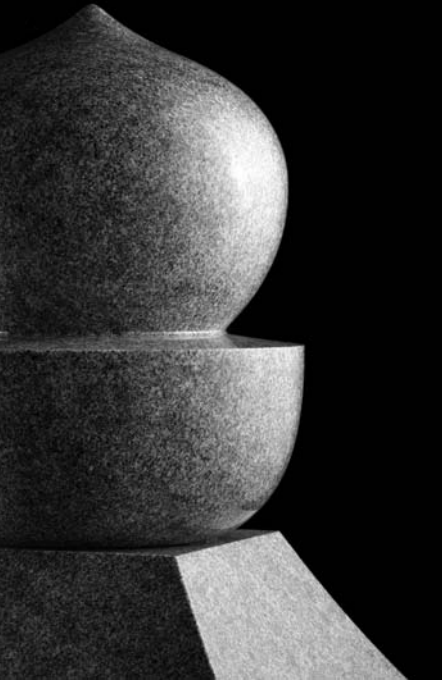
【2点】庵治産地で撮影された五輪塔上部と反花のアップ部分。平面は手動研磨機を使用し、R面や反花などの部分は、通常の倍以上の手間と時間を掛けて昔ながらの手擦りで仕上げた。これにより艶・質感・耐久性とも最高級の「究極の磨き」を実現。庵治石ならではの斑がキレイに浮き出ている
