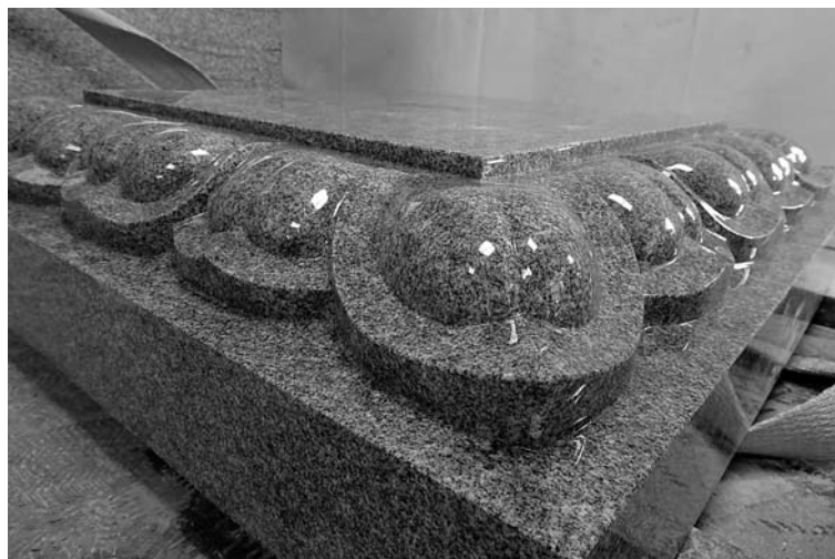
【2点】庵治産地で撮影された五輪塔上部と反花のアップ部分。平面は手動研磨機を使用し、R面や反花などの部分は、通常の倍以上の手間と時間を掛けて昔ながらの手擦りで仕上げた。これにより艶・質感・耐久性とも最高級の「究極の磨き」を実現。庵治石ならではの斑がキレイに浮き出ている
