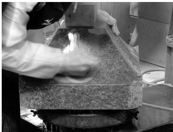
火輪の笠の部分は研磨パッドを使って手擦りで仕上げた
